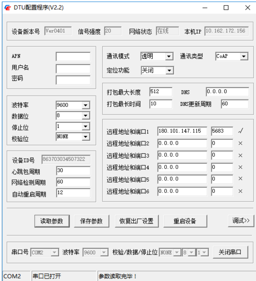
(图6) DTU配置程序读取参数
